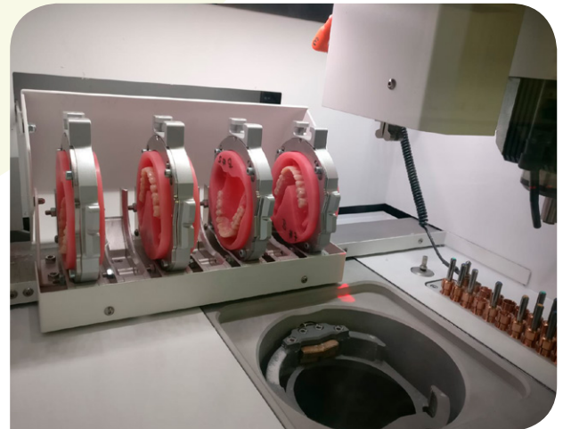
Blanks in machine klaar voor 2de deel frezen
