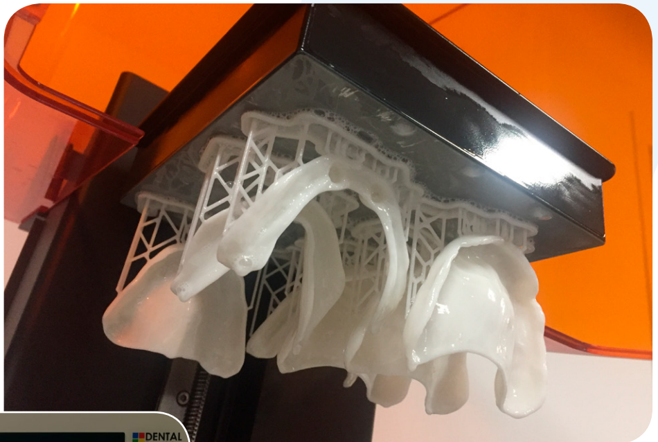
3D-geprinte afdruckpels en beetplaten
